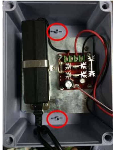
รูปที่ 2 แสดงตำแหน่งการเจาะยึด Fig.2 Position to fix with panel
